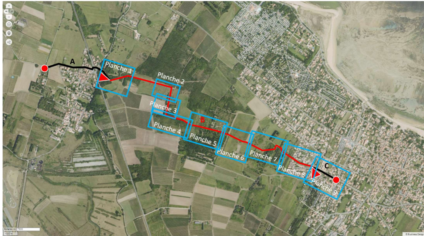
Figure 41 - Plan de situation des planches de plan topographique de l'état actuel du terrain (Source : CDCIO)
