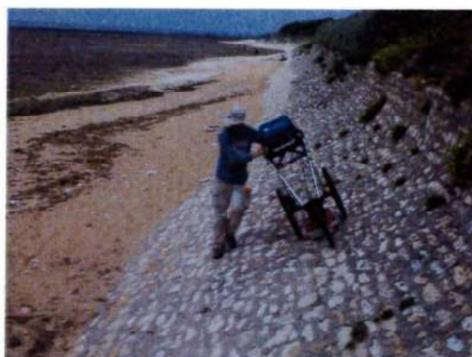
Photographie 1 : Mesure en mode « kart » (antenne 400MHz).
