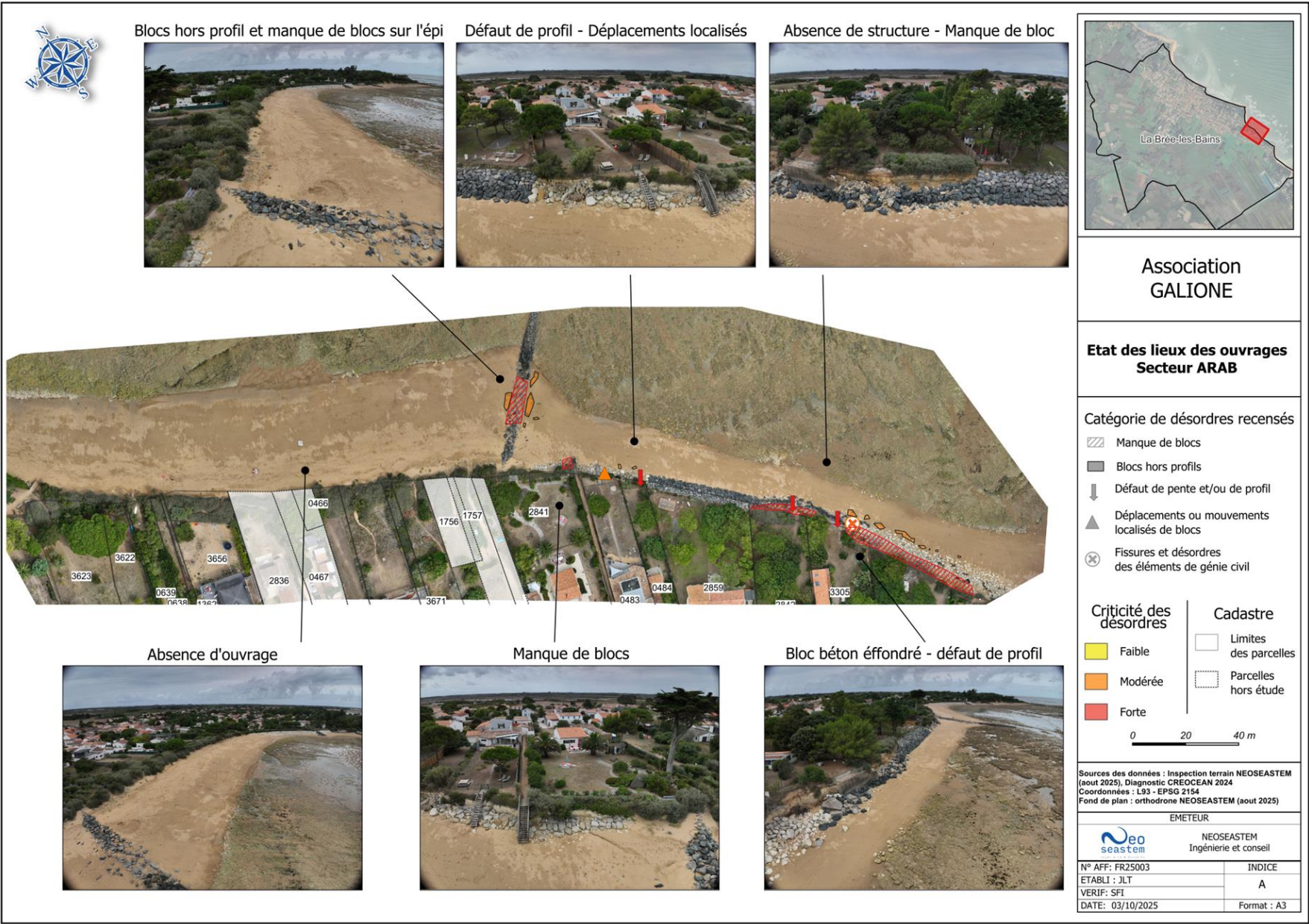
Planche 6 : Etat des lieux des ouvrages – Secteur ARAB (Neoseastem, Etudes techniques préliminaires, 2025)
